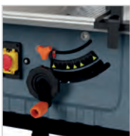
Ajuste de Ângulo e Regulagem de Altura
